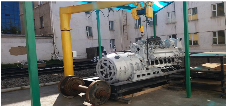
3.7 дугаар зураг. Илчит тэрэгний 14Д40 дизель генератор
